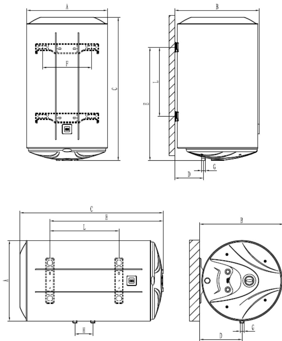
\*El modelo **TBL plus 100-150L** cuenta con dos soportes de montaje metálicos.
