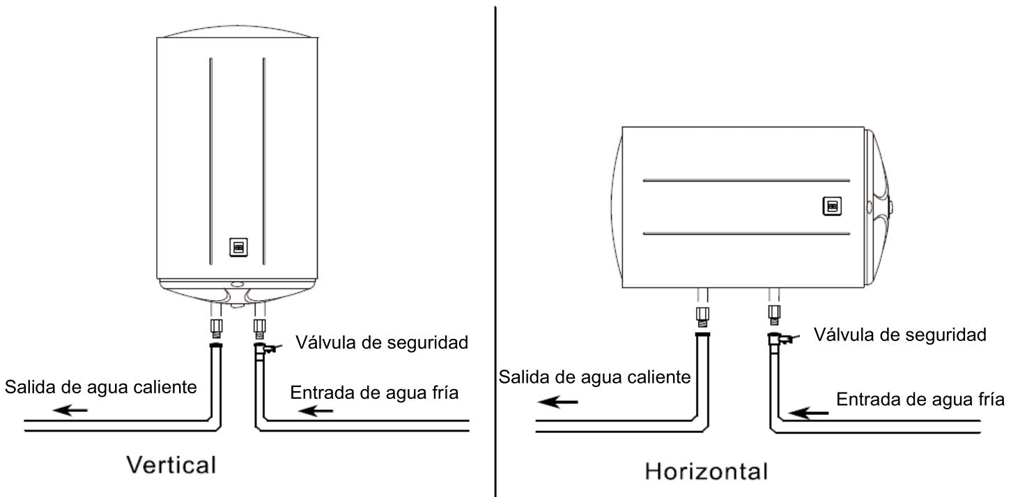
Ensarte la tubería de entrada de agua fría (azul) en la manguera electrolítica y de esta al subconjunto de seguridad hidráulica con el dispositivo de drenaje entregado con el calentador. Coloque una válvula de corte en la tubería de suministro de agua fría. **IMPORTANTE:** la válvula de corte debe estar siempre en la posición de abierto cuando el termo esté encendido.
