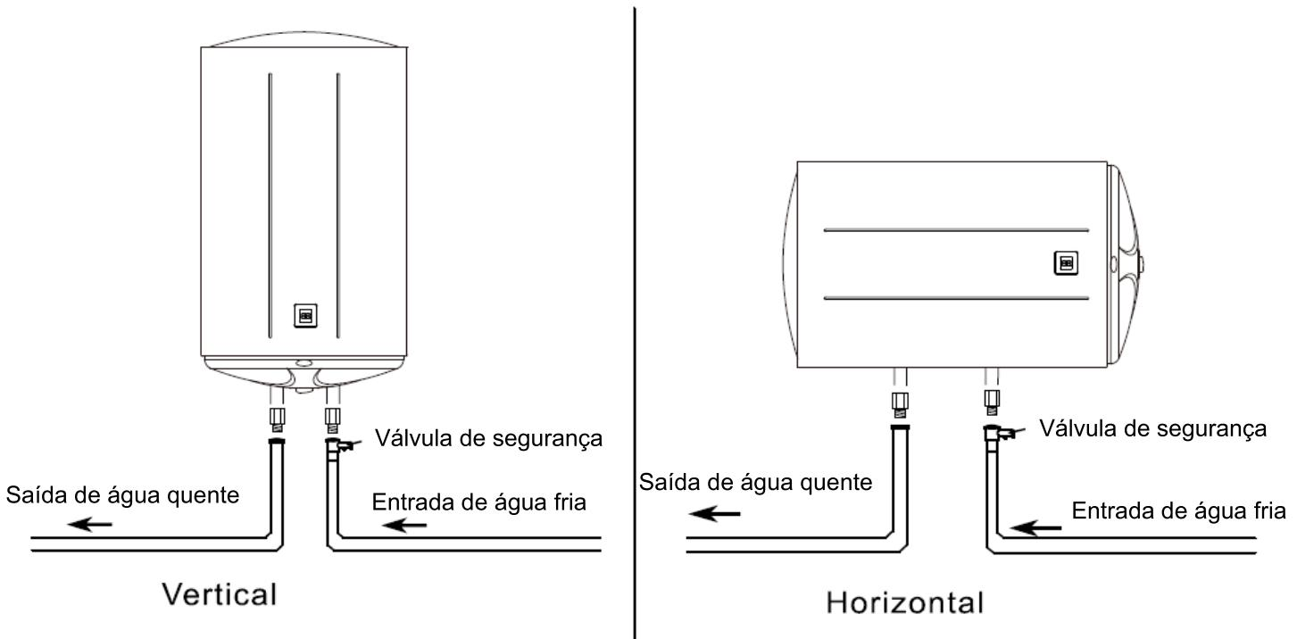
Enrosque o tubo de entrada de água fria (azul) na mangueira eletrolítica e esta ao subconjunto de segurança hidráulica com o dispositivo de drenagem fornecido com o aquecedor. Instale uma válvula de corte no tubo de abastecimento de água fria. **IMPORTANTE: a válvula de corte deve estar sempre na posição aberta quando o aquecedor está ligado.**
