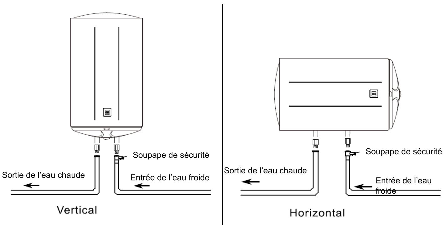
Enfiler le tuyau d'arrivée d'eau froide (bleu) sur le tuyau électrolytique et à partir de celui-ci sur le sous-ensemble de sécurité hydraulique avec le dispositif de vidange fourni avec le chauffe-eau. Installez une vanne d'arrêt sur le tuyau d'alimentation en eau froide. **IMPORTANT : la vanne d'arrêt doit toujours être en position ouverte lorsque le chauffe-eau est allumé.**
