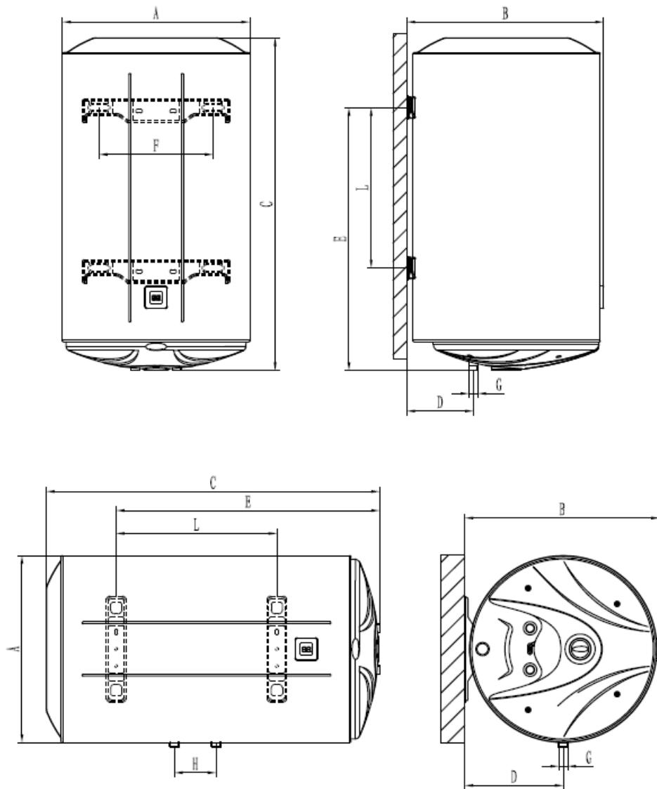
\*Le modèle **TBL plus 100-150L** possède deux supports de fixation en métal.
