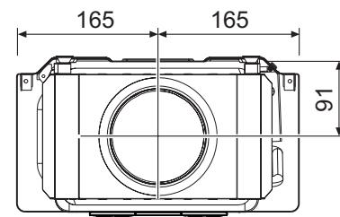
fig. 20 - Dimensions et raccords CADI 11
