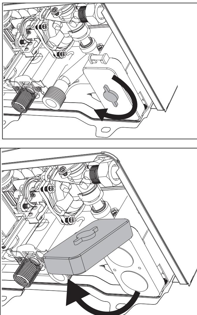
fig. 18 - Abertura do compartimento das pilhas.
