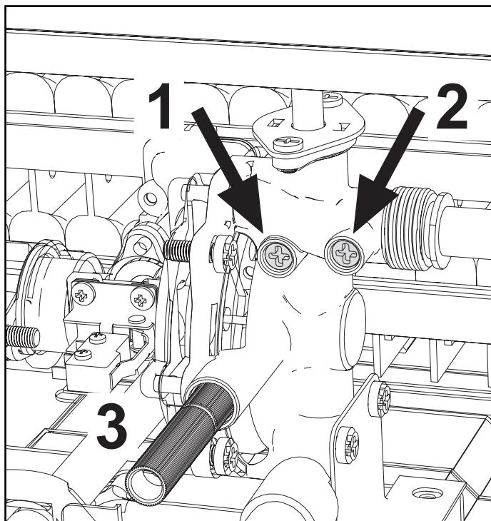
fig. 9 - Tornillos de regulación del caudal de agua
