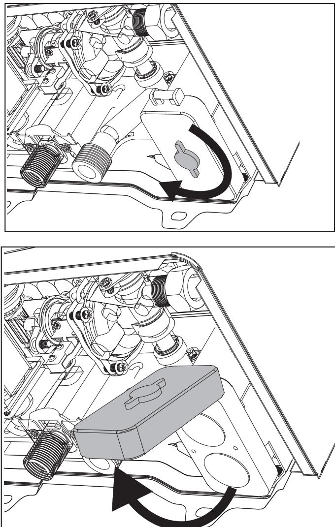
fig. 18 - Ouverture du compartiment à piles.
