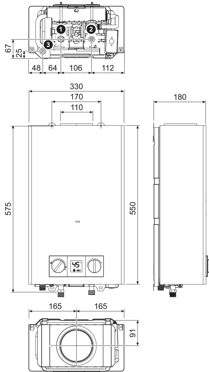
fig. 20 - Medidas y conexiones CADI 11
