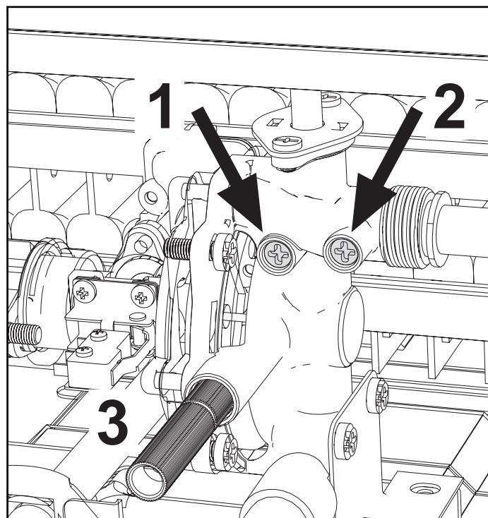
fig. 9 - Parafusos de regulação do caudal de água
