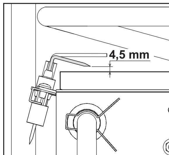
fig. 16 - Posizione elettrodo
