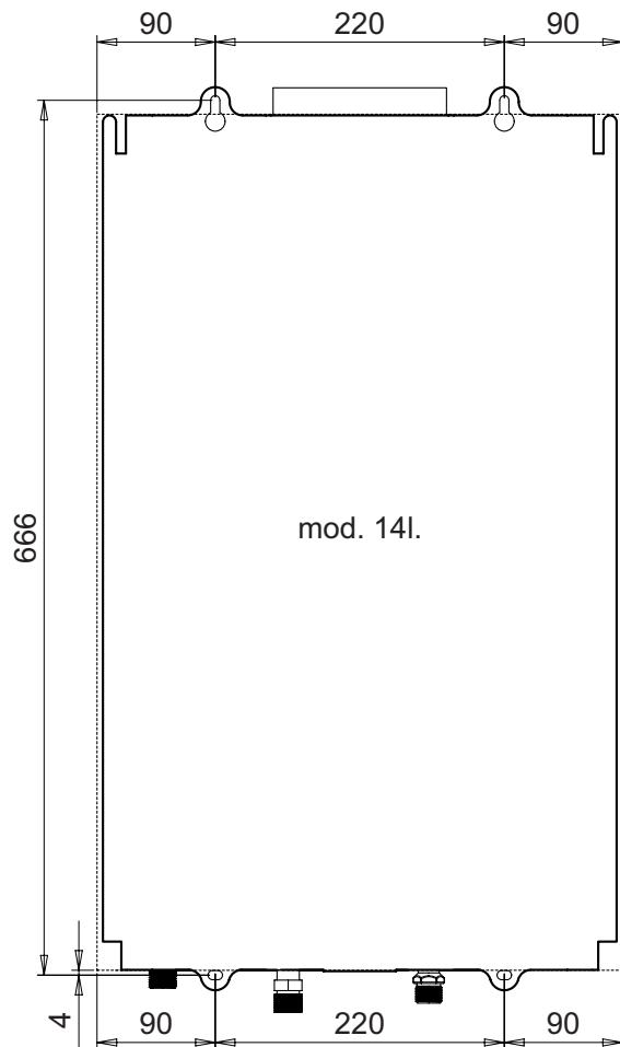
fig. 6 - Dima di montaggio CADI 14
