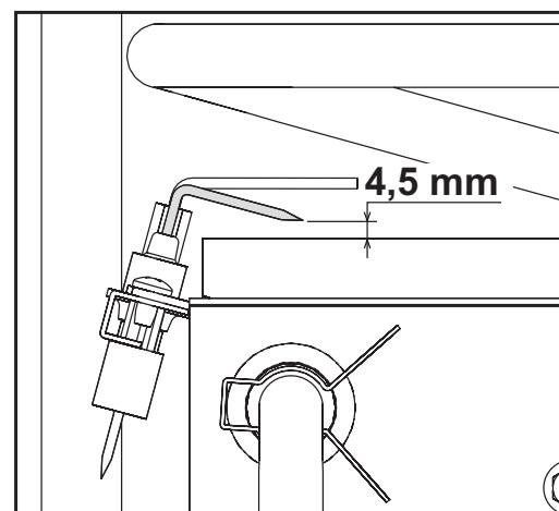
fig. 16 - Posição do elétrodo
