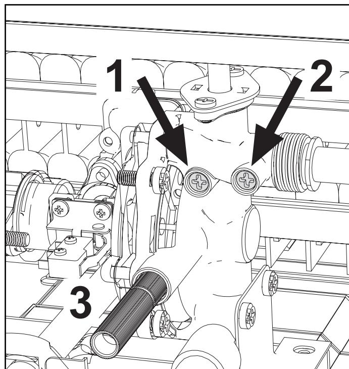
fig. 9 - Viti regolazione portata acqua
