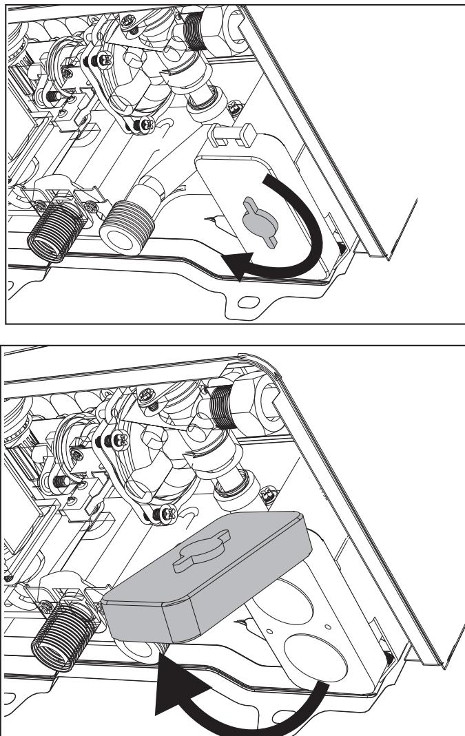
fig. 18 - Apertura dello scomparto delle batterie.
