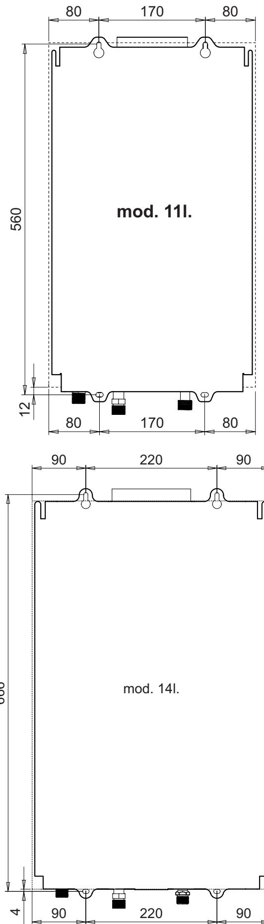
fig. 6 - Dima di montaggio
