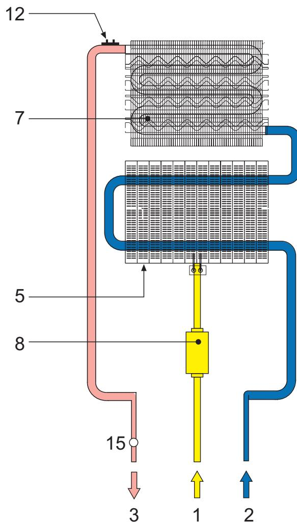
fig. 25 - Circuit hydraulique
