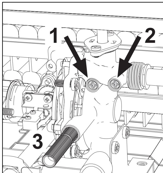
fig. 9 - Vis de réglage du débit d'eau
