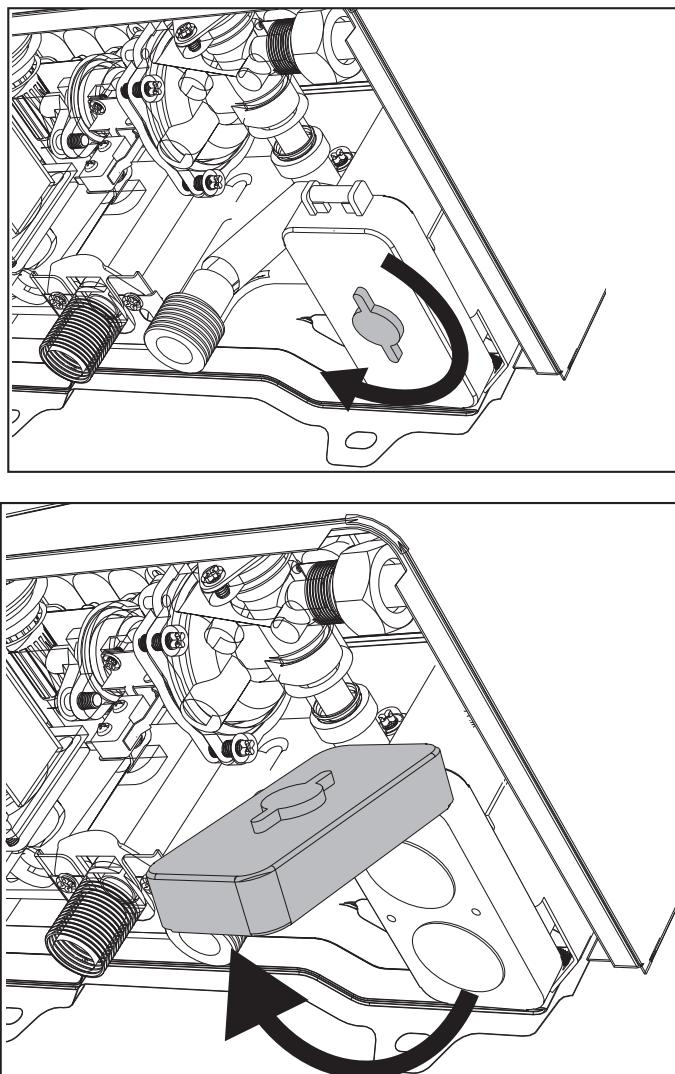
fig. 18 - Apertura del alojamiento de las pilas
