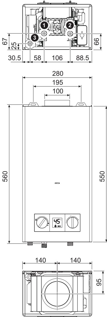
fig. 19 - Medidas y conexiones CADI 6
