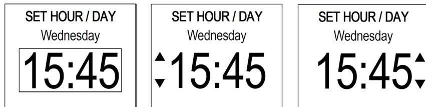
Quando terminar a vida útil da bateria da pilha de botão (pág. 31), depois de um corte de energia ou uma desconexão da rede elétrica por mais de um minuto, o emissor solicitará ao usuário a configuração da hora / dia, já que o relógio do sistema será reiniciado na segunda-feira, 00:00.
