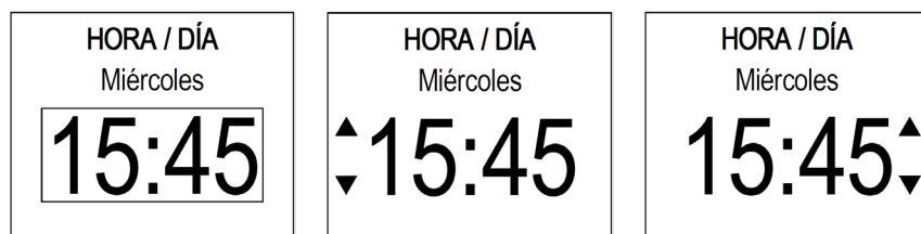
Cuando finaliza la vida útil de la batería de la pila botón (consulte la pág. 12), después de un corte de energía o una desconexión de la red eléctrica de más de un minuto, el emisor solicitará al usuario que ajuste la hora / día, ya que el reloj del sistema se reiniciará en lunes 00:00.
