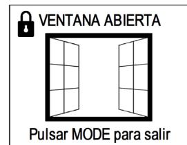
Cuando la función Ventanas abiertas se ha activado, se indica en la pantalla mediante una sola pantalla con una ventana abierta.
