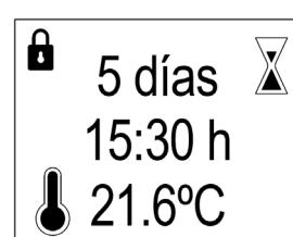
En el caso de que el emisor se desconecte de la red eléctrica, se guardarán los ajustes del modo Manual y el tiempo restante seguirá contando hacia atrás aunque el emisor esté apagado.
