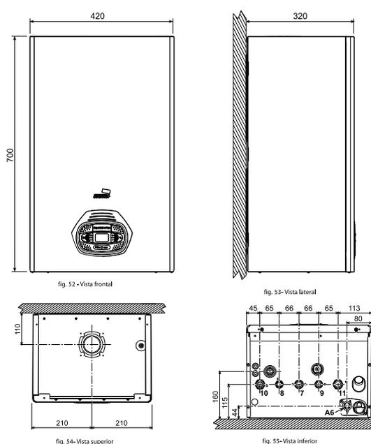
**7** Entrada de gas - Ø 3/4" **8** Salida de ACS - Ø 1/2" **9** Entrada de AS - Ø 1/2" **10** Ida a calefacción - Ø 3/4"
