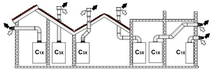
Fig. 2 - Exemple de branchement avec des tuyaux coaxiaux
