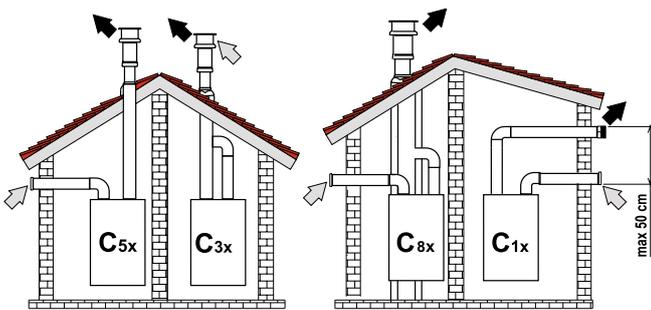
Fig. 3 - Ejemplo de conexión con tubos separados
