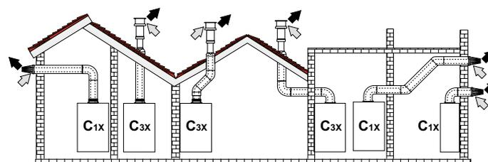
Fig. 2 - Exemplo de ligação com tubos coaxiais
