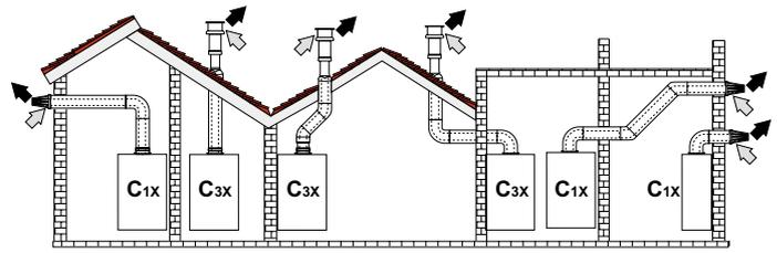
Fig. 2 - Ejemplo de conexión con tubos coaxiales
