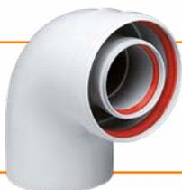
1 codo sólo resta 0,5 m (con tubo coaxial Ø80/125)
