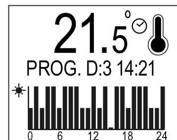
Esta função só trabalha no modo Programação. No ecrã de programação, quando a função trabalha (estando habilitada), aparece mediante um ícone de relógio intermitente junto ao símbolo de termómetro, até que chegue a hora do modo seguinte já definido (de aquecimento apagado a eco / conforto, ou de eco a conforto).
