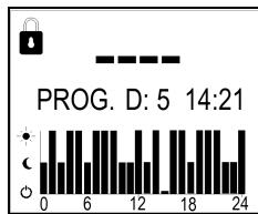
Sobre la barra de la hora actual se muestra un pequeño triángulo a modo de índice. En el eje vertical del gráfico de barras se muestra sólo el ícono del modo de la hora actual
