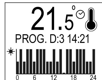
Esta función sólo trabaja bajo el modo Programación. En la pantalla de programación, cuando trabaja la función (si está habilitada), se muestra mediante un ícono de reloj parpadeando junto al símbolo de termómetro, hasta que llegue la hora del siguiente modo ya adelantado (de calentamiento apagado a eco / confort, o de eco a confort).
