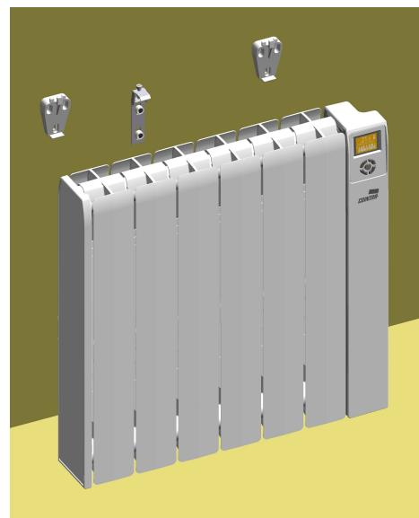
3. Perfurar a parede nas marcas efectuadas, colocar os tacos, aparafusar os suportes e suspender o emissor.
