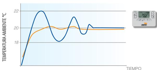
La función modulante de los cronocomandos W AF (por radio) permite **modular la potencia** de la caldera a medida que se alcanza el **valor de la temperatura ambiente** configurado. Esto mejora la calidad del confort eliminando los picos de calor, con un consiguiente ahorro energético.
