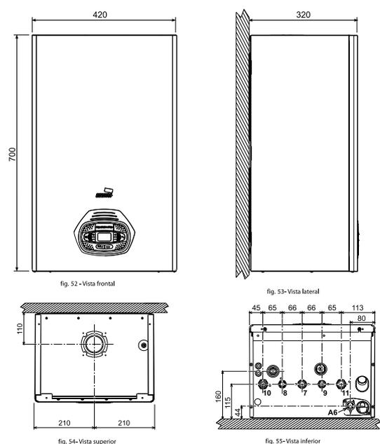
7 Entrada de gas - Ø 3/4" 8 Salida de ACS - Ø 1/2" 9 Entrada de AS - Ø 1/2" 10 Ida a calefacción - Ø 3/4"
